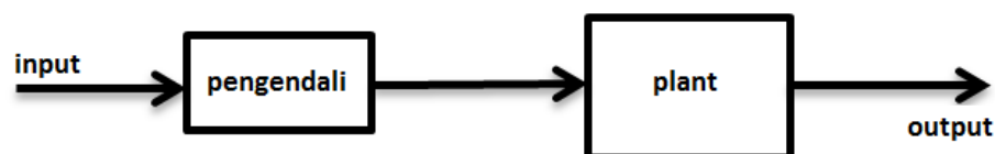
Gambar 3.1 Diagram blok sistem pengendalian lingkaran terbuka
