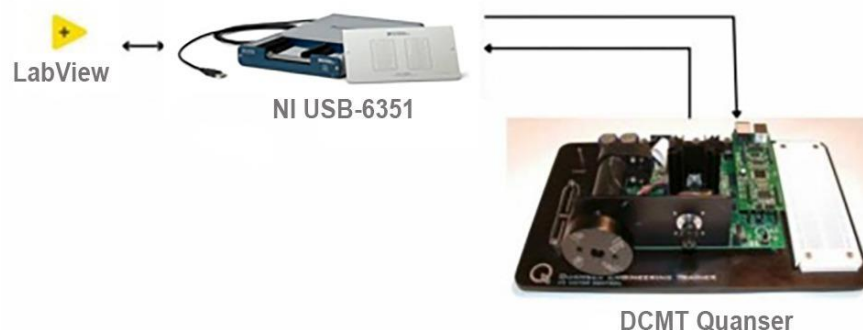
Gambar 4.4 Koneksi hardware untuk sistem pengendalian kecepatan
